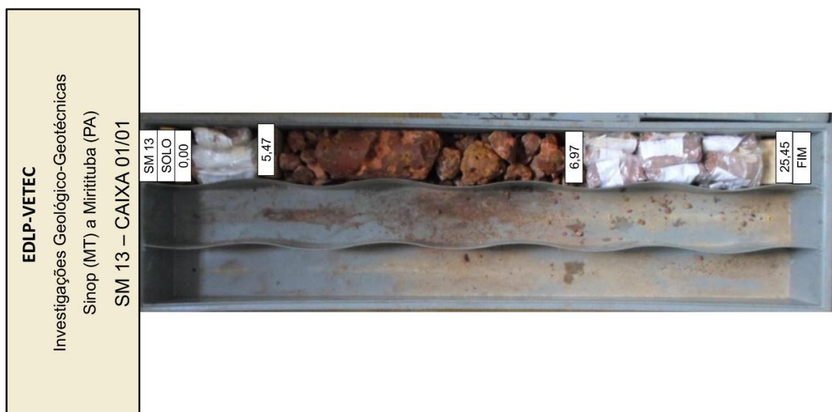
Foto 8 – Amostras da SM-13, destacando a laterita entre 5,47 e 6,97 m e a ocorrência de horizontes de solo novamente abaixo da laterita, neste caso com grande espessura.
