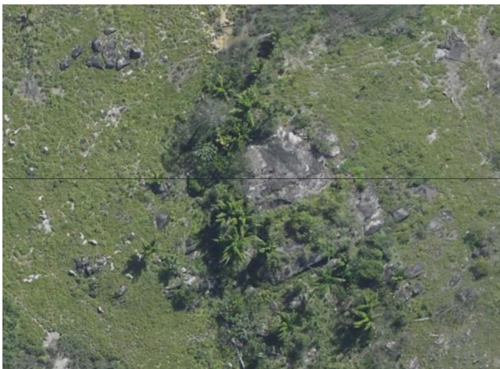
Figura 12 – Ocorrências de blocos de rocha e afloramentos em ortofoto, próximo do km 432 + 750, do traçado da EF-170.
